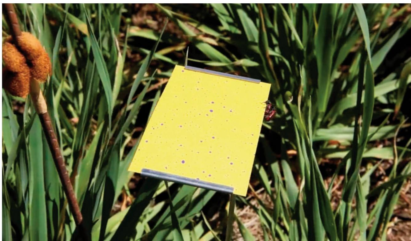
**Foto 1.** Estación colectora con una tarjeta hidrosensible. En ella se pueden visualizar las gotas colectadas, de color azul, producto de una aplicación<sup>7</sup>.
