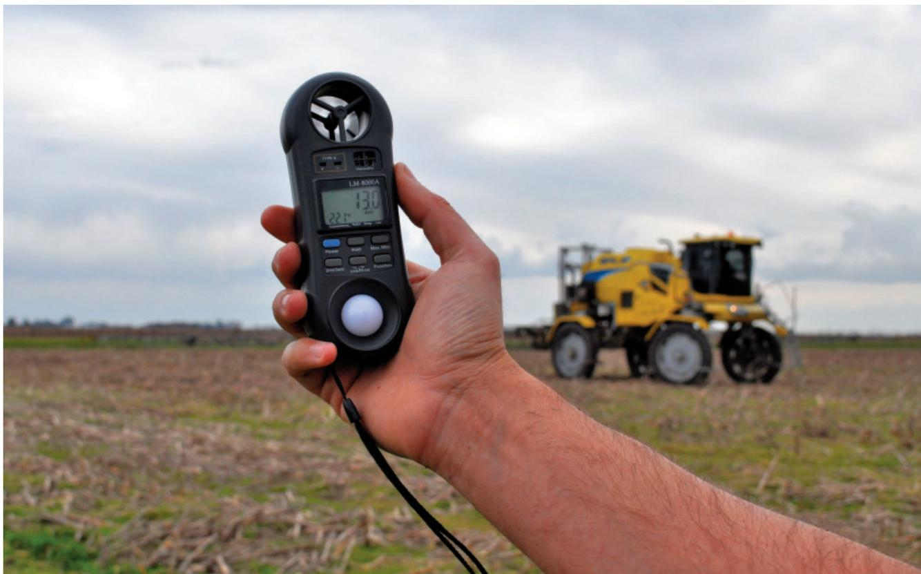
Foto 2. Equipo multiparamétrico o higr-termo-anemómetro portátil (Fuente: CASAFE).
